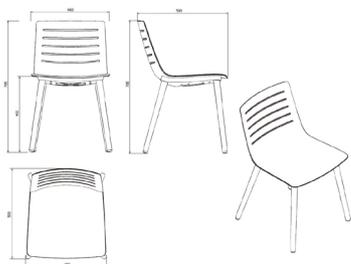
Silla para uso interior. Carcasa asiento y base de patas inyectadas en polipropileno con fibra de vidrio. Patas de madera. Sistema de montaje mediante clipaje. Protección UV.
